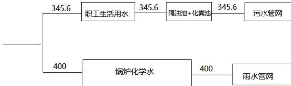
**图 2-3 本项目水平衡图（单位：t/a）**
